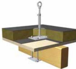
Anschlagpunkt zur Befestigung mit Konterplatte um Träger oder Balken
