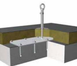
Anschlagpunkt zur Befestigung auf Porenbetondeckenelementen - mind. Festigkeitsklasse P3.3
